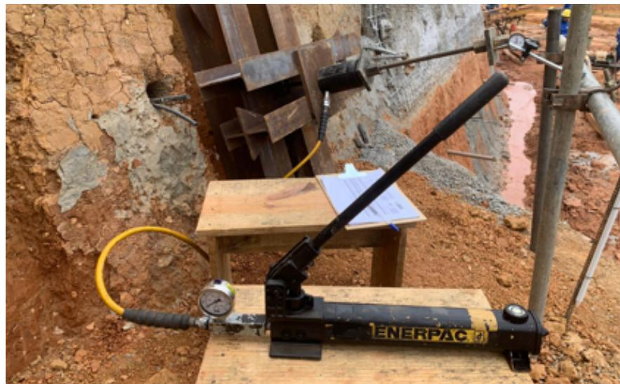
Figura 13: aparelhagem montada para o ensaio de arrancamento
