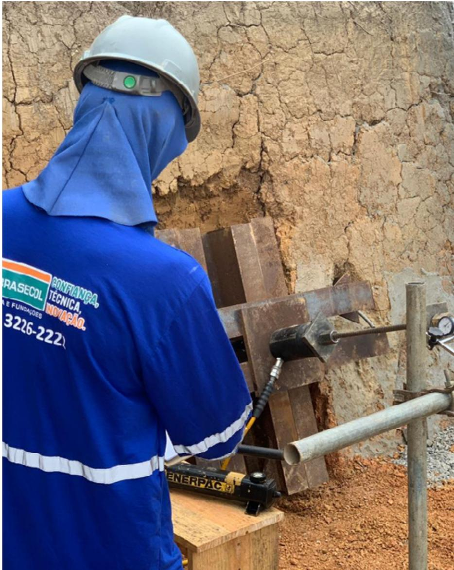
Figura 14: realização de ensaio de arrancamento
