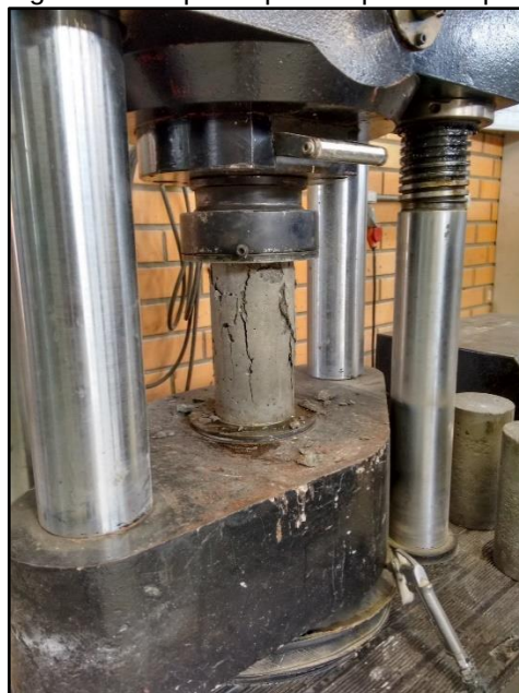
Figura 24: Corpo de prova após da ruptura
