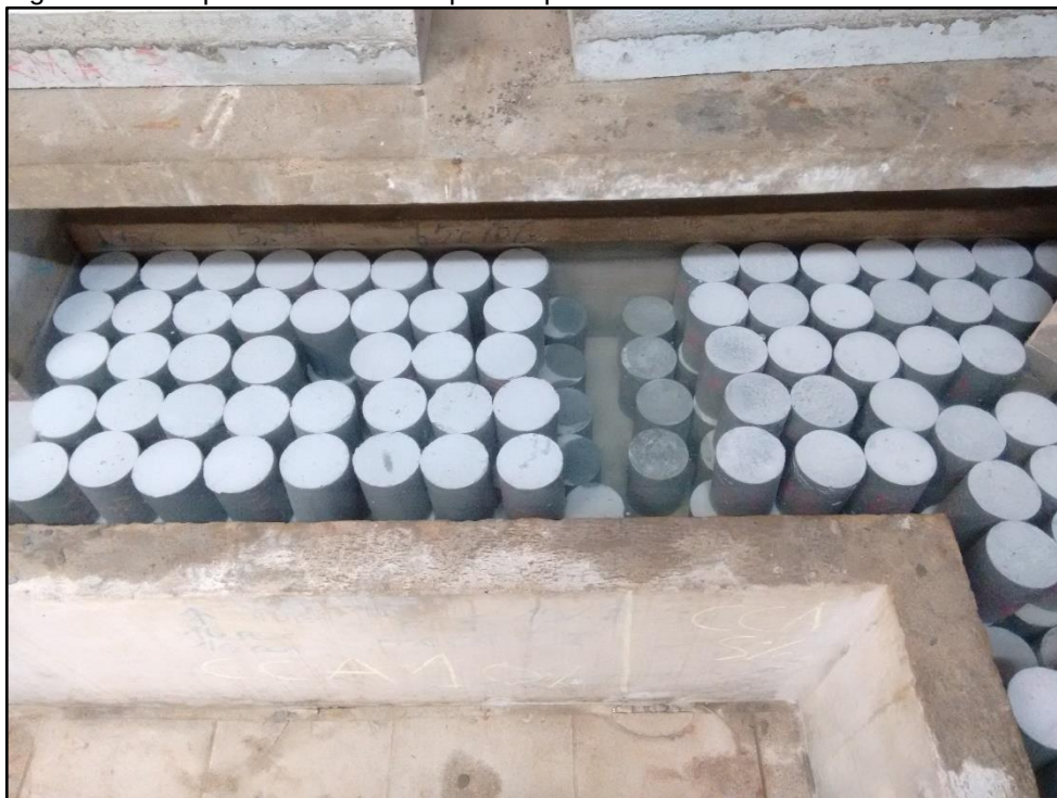
Figura 21: Tanque de cura dos corpos de prova
