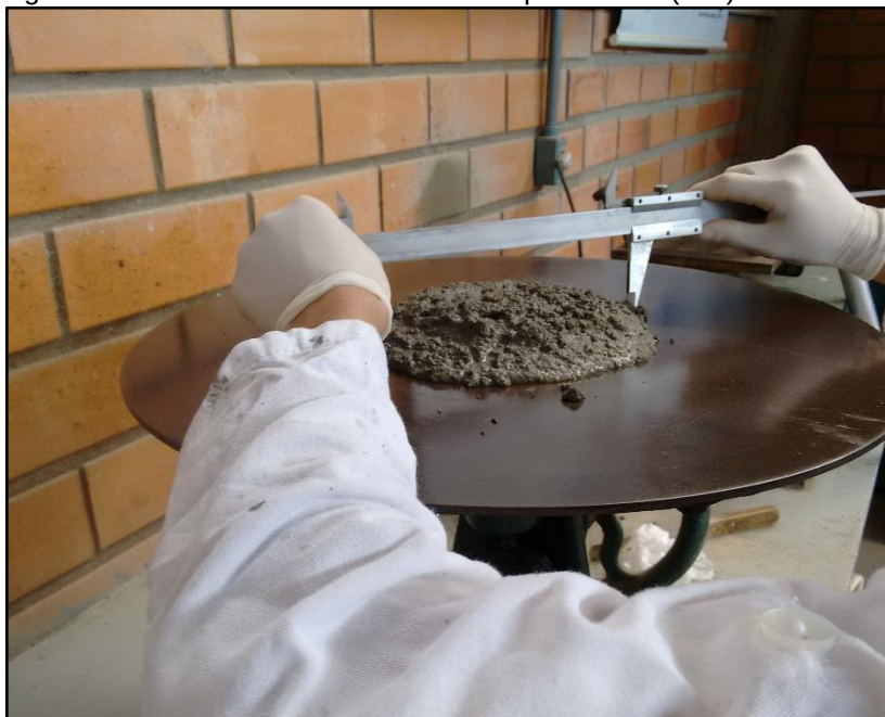
Figura 12: Ensaio de índice de atividade pozolânica (IAP)
