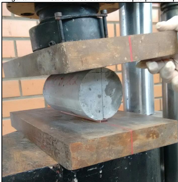
Figura 25: Ensaio de resistência à tração por compressão diametral
