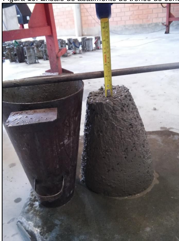
Figura 19: Ensaio de abatimento de tronco de cone ( slump test )
