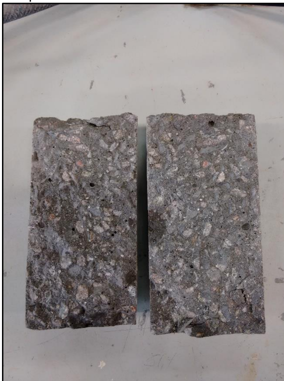
Figura 26: Corpos de prova após o ensaio de resistência à tração por compressão axial
