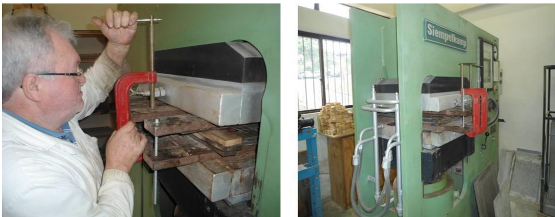
Figura 19. Processo de Montagem dos painéis
