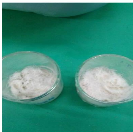
Figura 15. Ensaio do teor de extrativos em NaOH
