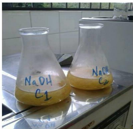
Figura 15. Ensaio do teor de extrativos em NaOH
