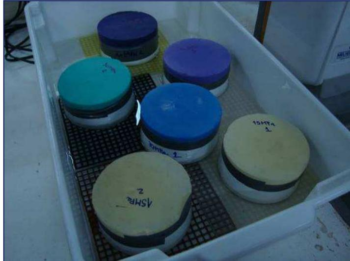
**Figura 27 - Ensaio de absorção de cloretos**
