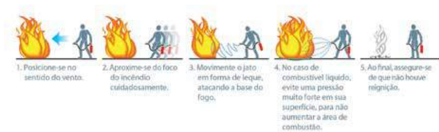
Figura 17 – Utilização de Extintores Portáteis
