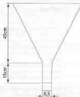
Figura 3 - Funil para ensaio de viscosidade.
