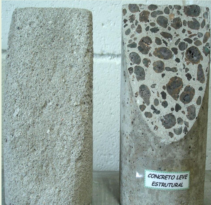
Concreto leve celular com espuma
