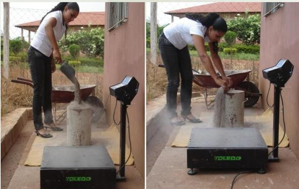
A massa unitária é utilizada para transformar os materiais utilizados em massa para volume com vazios (dosado em obra).
