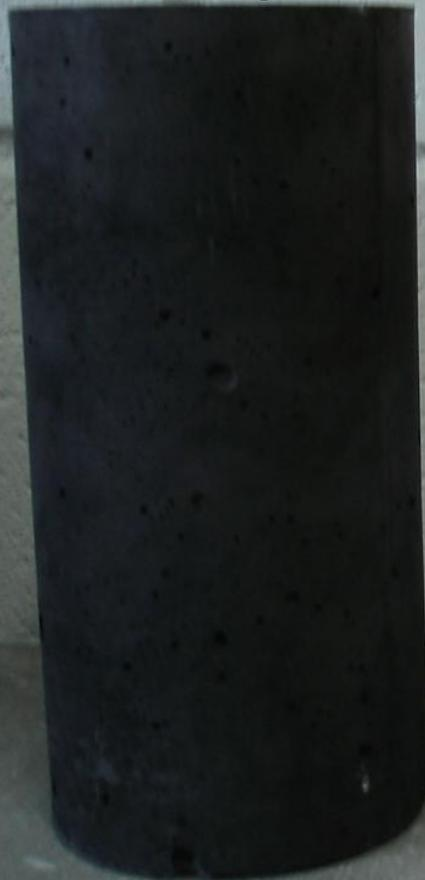
**Concreto com cimento branco agregado normal**
