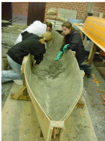
Figura 16 - Execução da segunda camada da canoa da Equipe 5.
