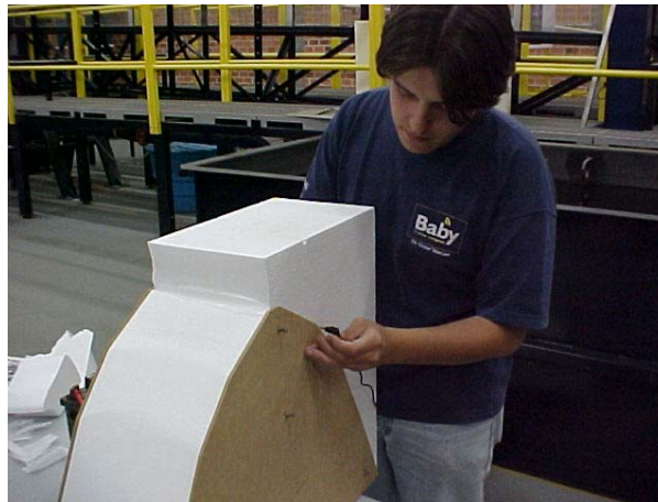
Figura 7 - Corte das camadas de isopor para forma.
