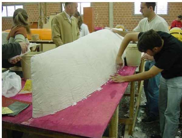
Figura 8 - Acabamento da forma de isopor com gesso.
