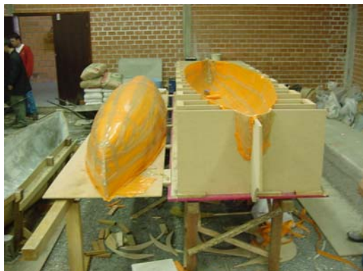
Figura 10 - Forma macho-fêmea em lona plástica.
