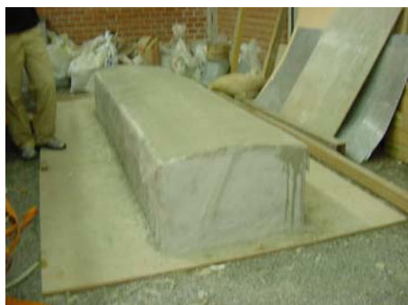
Figura 13 - Junta fria na segunda camada da canoa da Equipe 2.
