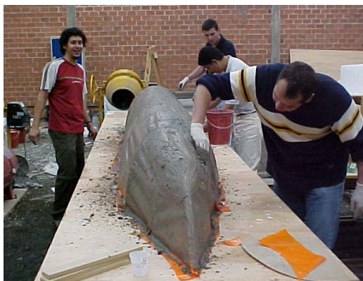
Figura 18 - Execução da canoa da Equipe 7.
