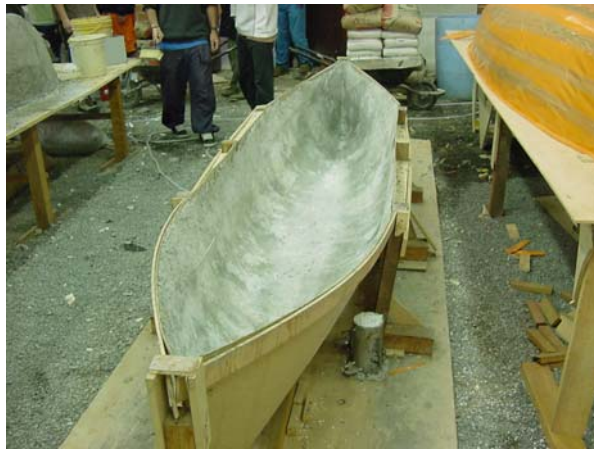
Figura 6 - Forma externa em MDF.
