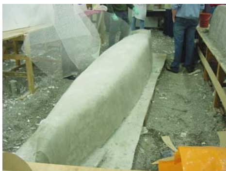
Figura 15 - Tela aplicada sobre o concreto seco na canoa da Equipe 4.
