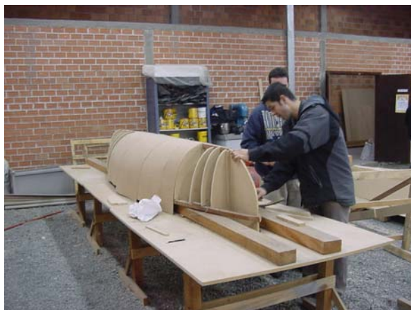
Figura 5 - Montagem de uma forma interna em MDF.
